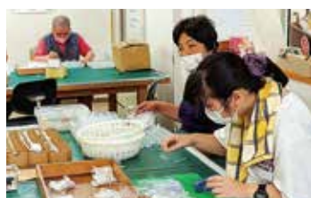
プラスチック製品のバリ取り作業
